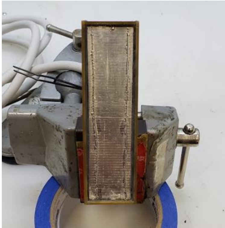
Figura 51 – Conexão dos fios de terra ao eletrodo posterior
