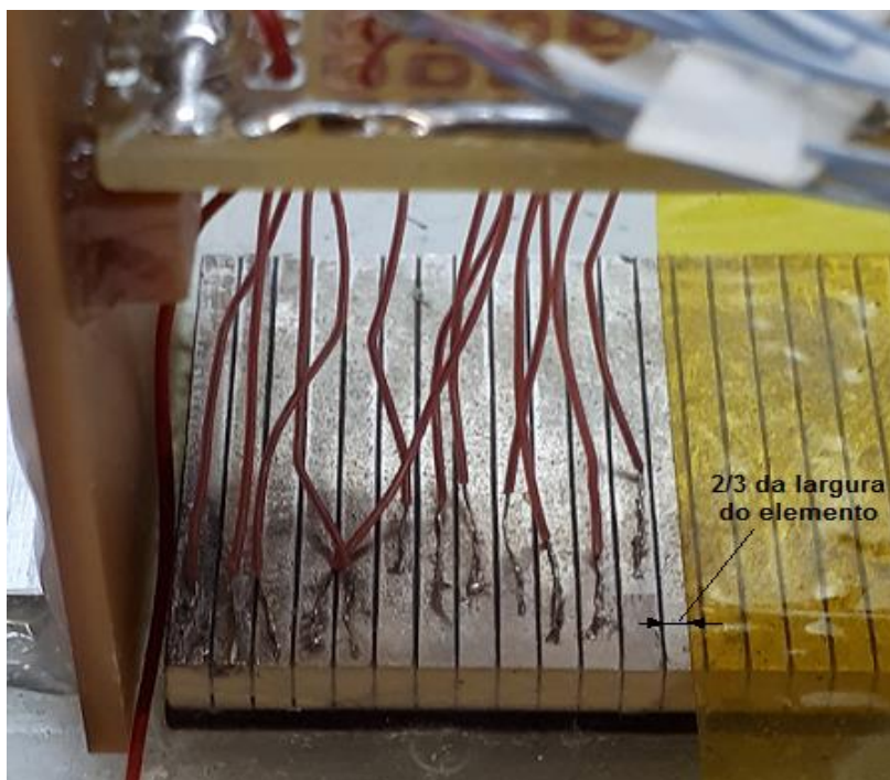
Figura 49 – Posicionamento correto da fita adesiva sobre o eletrodo
