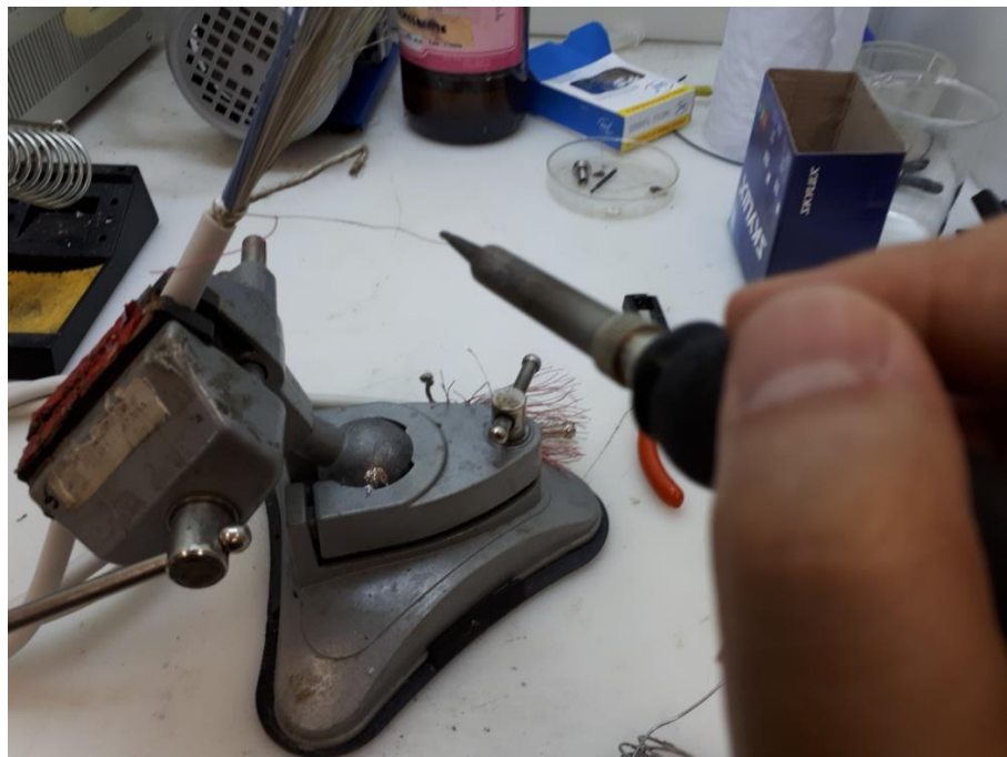
Figura 43 – Tela metálica reagrupada e ponteadada
