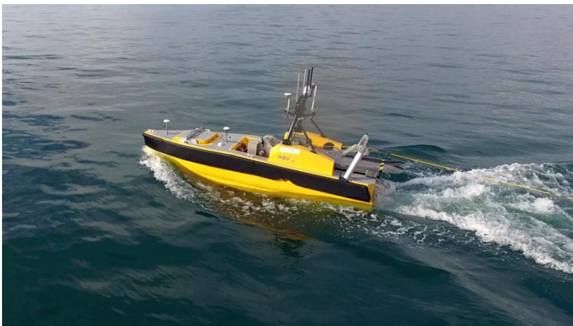
Figura 2 - Embarcação autônoma realizando operação de batimetria em água rasa
