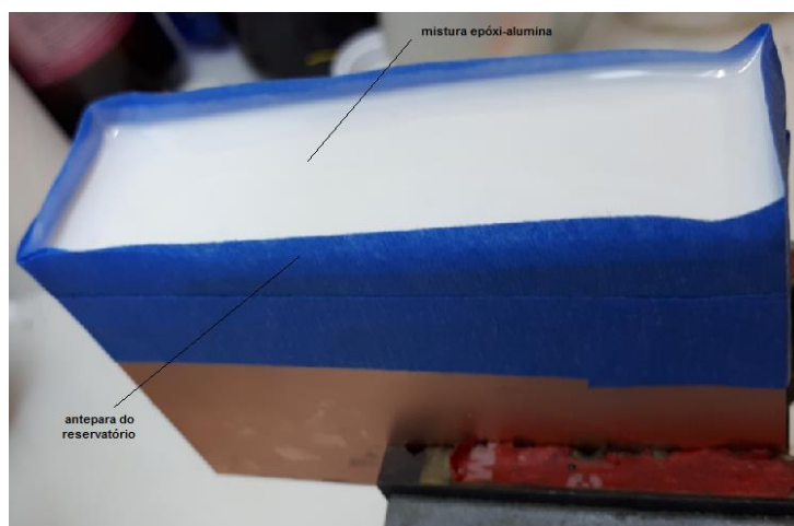
Figura 56 – Antepara e referência de nível para o enchimento do reservatório
