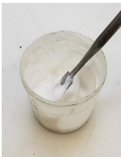
Figura 54 – Mistura da resina epóxi com pó de alumina
