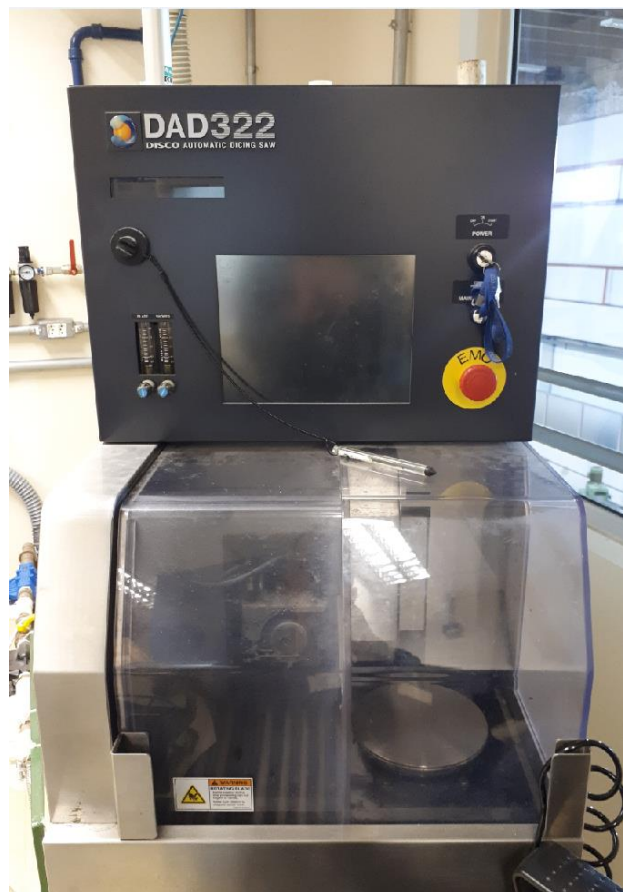
Figura 34 – Máquina automática de precisão usada no corte da cerâmica
