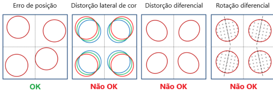
Figura 3.14: Erros comuns de mapeamento de pupila que impactam nas medidas de deslocamento.
