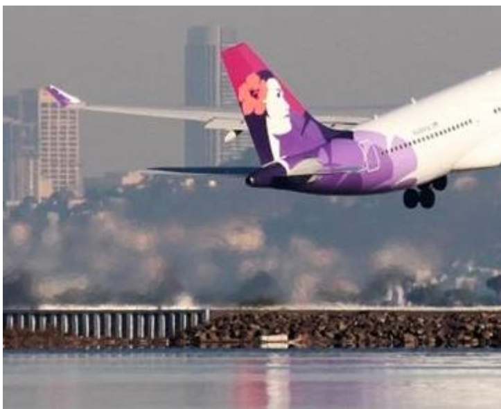
Figura 2.9: Distorção na imagem causada pelos motores de um avião. Fonte: Louis Nastro/Reuters
