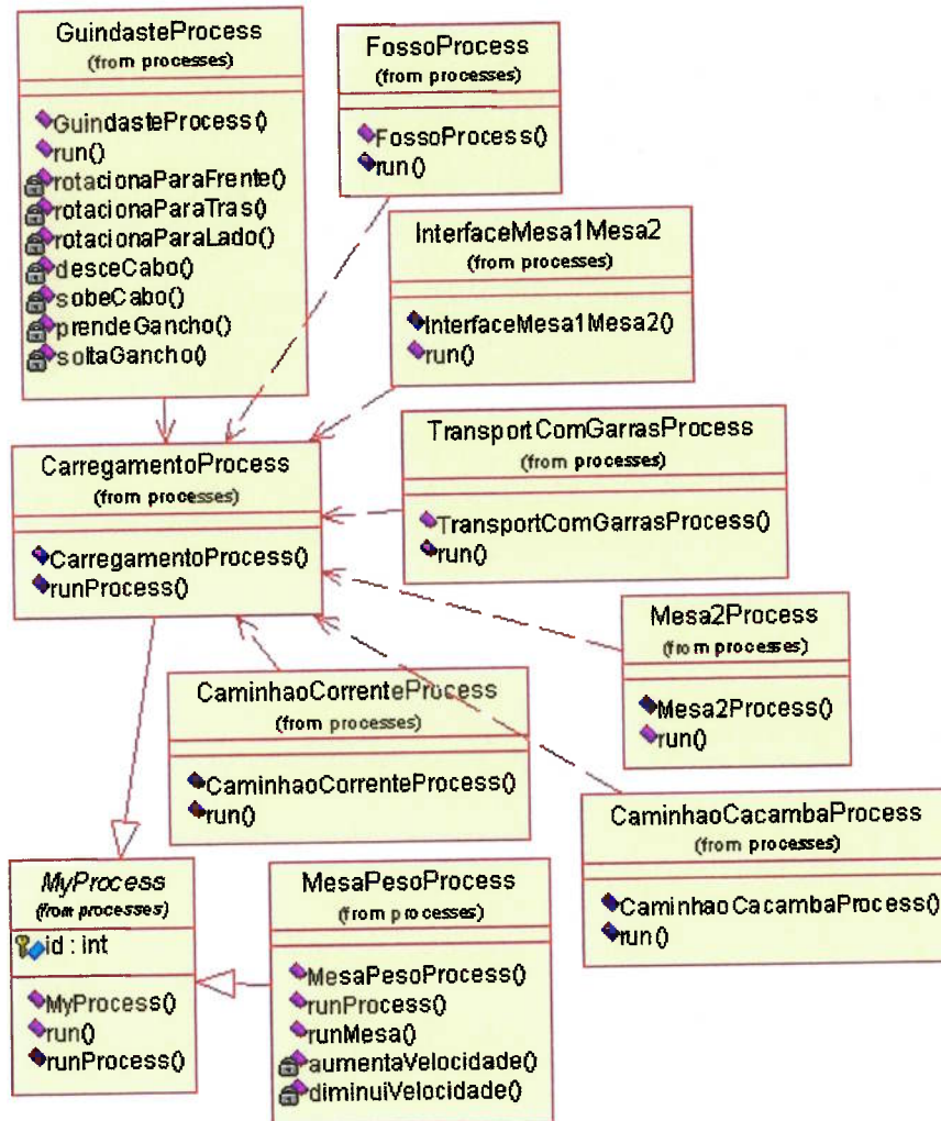
Figura 5.4: Processos do sistema de carregamento de cana-de-açúcar.
