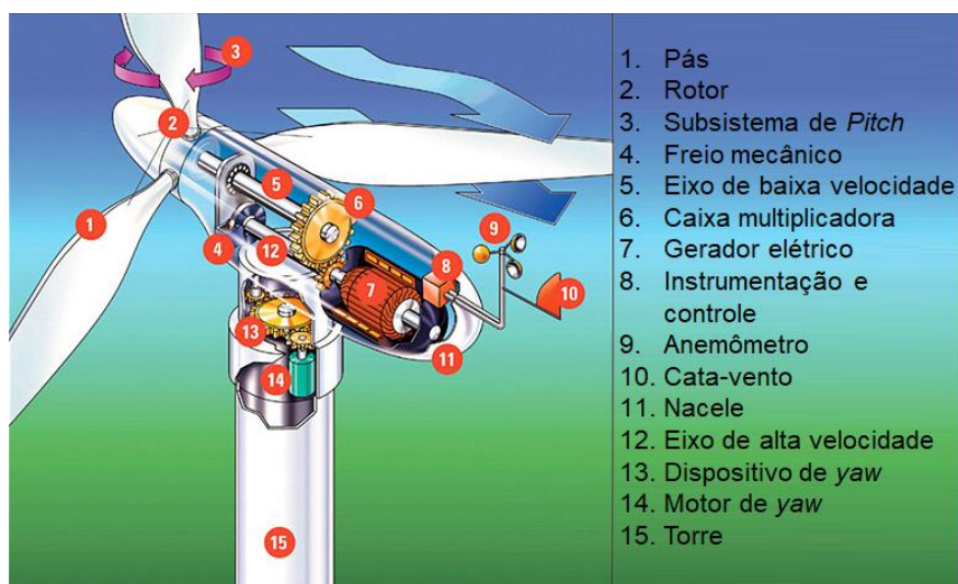
Figura 36 - Componentes detalhados de um aerogerador 30 .
