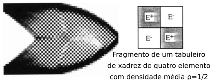
Figura 9 – Padrão conhecido como tabuleiro de xadrez e o gradiente de cinza entre a transição entre o material sólido e vazio
