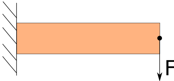
Figura 50 – Problema de OT em uma viga Cantilever Beam com aplicação da força no centro da ponta
