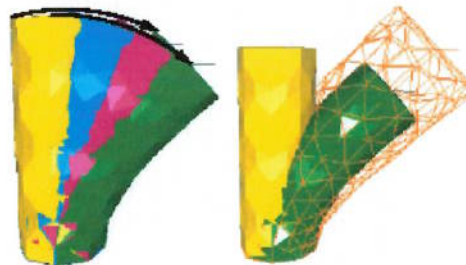
Figura 2-Deformação de um cilindro usando um modelo não linear.
