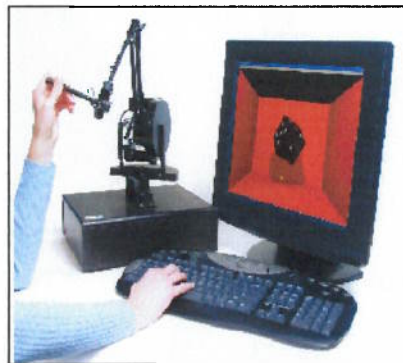
Figura 11- Realimentação de forças e monitoramento de posição em seis graus de liberdade.
