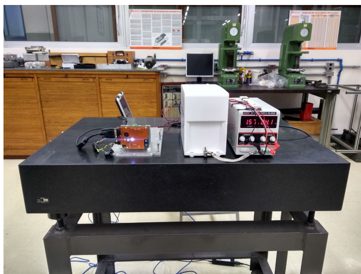
Figura A.1 – Setup para o teste de levantamento da curva de Allan.
