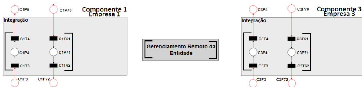
Figura 66 – Modelo no nível de “Integração” do Componente 1 Empresa 1 e do Componente 3 Empresa 3 na interação M2M entre Empresas
