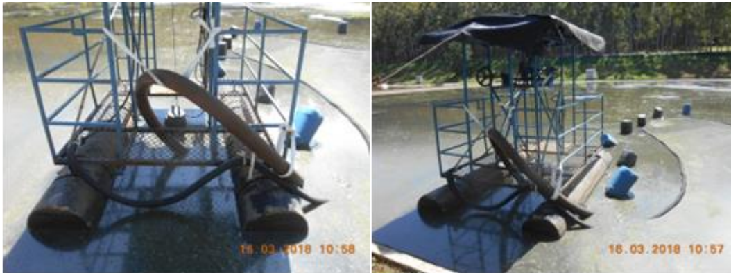
Figura 9 – Imagens de exemplo de balsa de desassoreamento alimentada por gerador a diesel (gerador fora da imagem)
