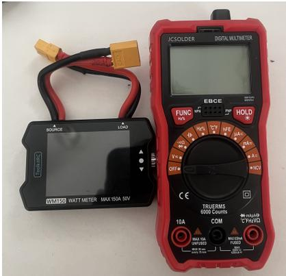
(a) Wattímetro ToolkitRC WM150 e multímetro JCSOLDER.
