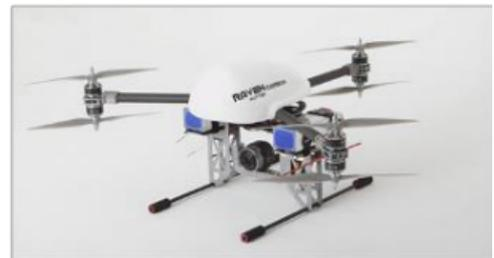
(b) VANT multirotores, AKS Raven X8.
