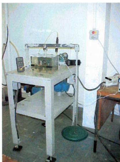
Figura 4.1. Sistema de aplicação de carga da bancada original.
