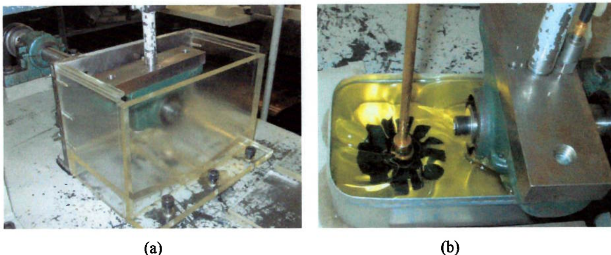
Figura 4.3. (a) Caixa de acrílico do sistema de lubrificação da bancada original; (b) Novo sistema de agitação.
