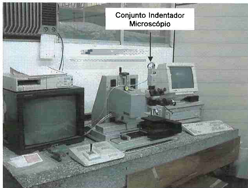
Figura 26. Equipamento para medidas de indentação instrumentada [62]
