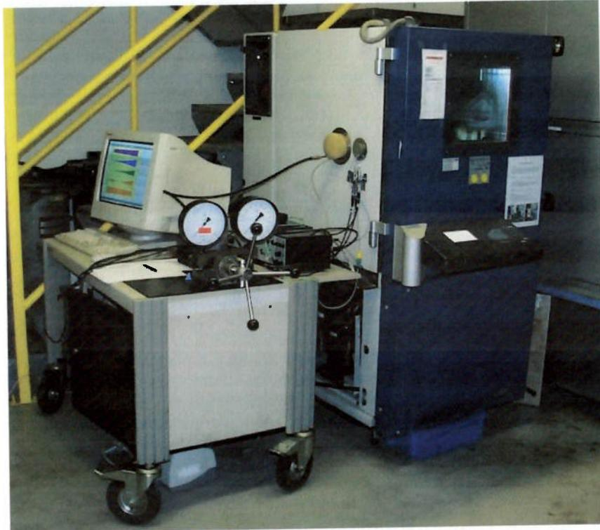
**Figura 5-14 – Montagem utilizada na medição sob diferentes temperaturas.**
