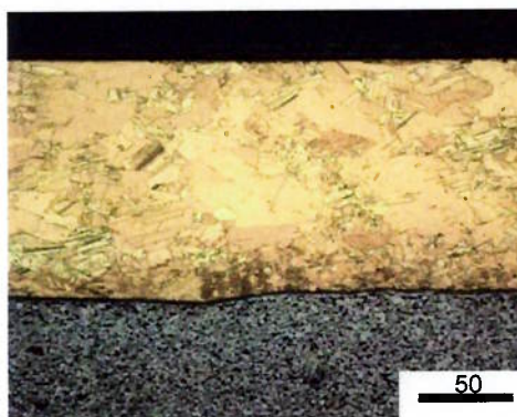
Figura 3-2: Microestrutura do material do corpo-de-prova revelada por uma solução de cloreto férrico com ácido clorídrico (3,5 g de \text{FeCl}_3 + 25 ml de \text{HCl} + 75 ml de álcool etílico).
