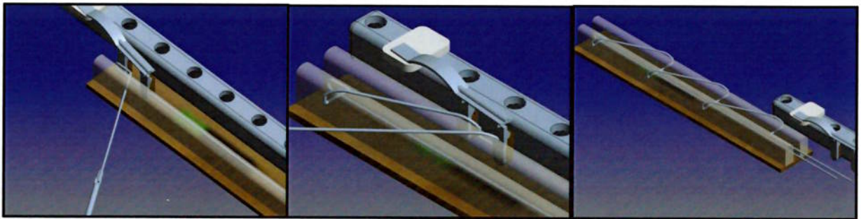
Figura 7.4 – Mecanismo de captura do fio através da agulha de crochê tunisiano. À esquerda, Agulha de crochê tunisiano se movendo até que todo o fio tenha passado pela aponeurose e o loop tenha sido desmanchado. Ao meio, Subsistema 3 (Movimentação das presilhas) reposiciona o fio para o outro lado da aponeurose. À direita, Término do procedimento, sutura contínua com inversão de bordas.
