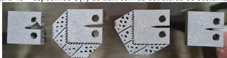
Figura 40 – espécimes C(T) as-built com as estruturas de sustentação.
