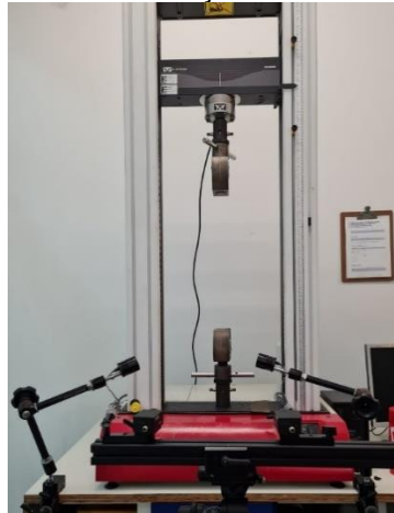
Figura 28 – Equipamento de Ensaio Universal: INSTRON 3369 Utilizados para Ensaios de Tração.
