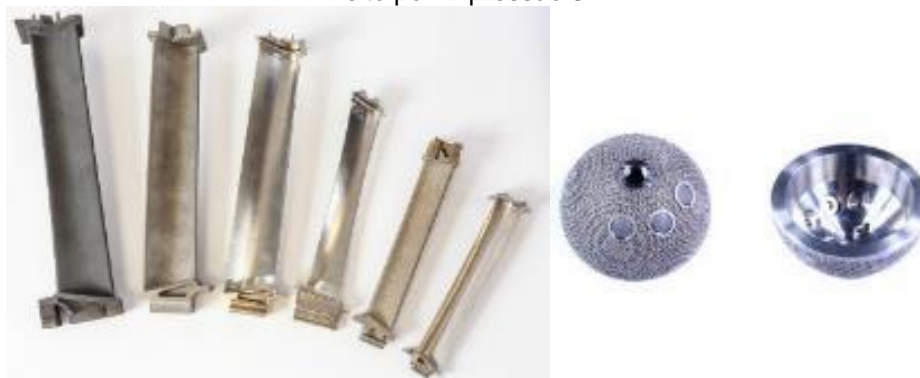
Figura 1 – a) Pás do motor GE9X feitas por impressão 3D. b) copo acetabular para implantes feito por impressão 3D.
