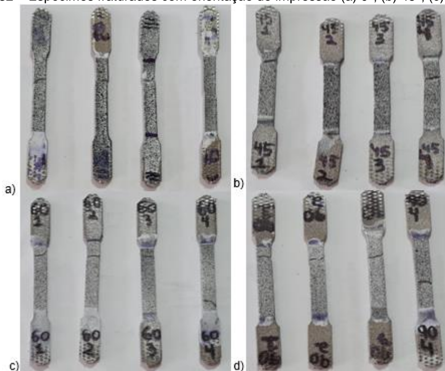
Figura 32 – Espécimes fraturados com orientação de impressão (a) 0^\circ , (b) 45^\circ , (c) 60^\circ e (d) 90^\circ .
