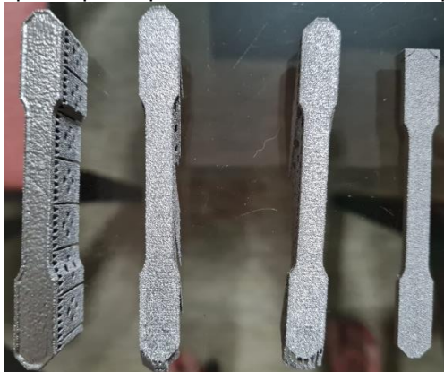
Figura 26 – Corpo de prova padrão com estrutura de suporte acoplada.
