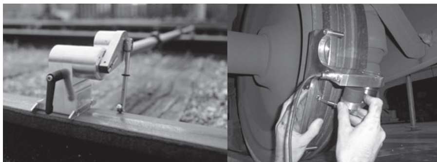
Figura 3.9: Medições dos perfis de um trilho e de uma roda através do miniprof. Extraído de Iwnicki, Björklund e Enblom (2009)
