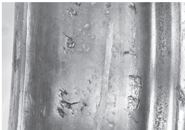
Figura 3.18: Dano por fadiga na superfície de uma roda. Extraído de Lewis e Olofsson (2009)
