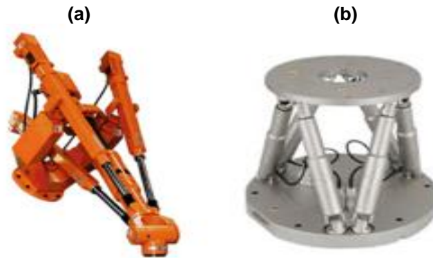
Figura 3 - Exemplos de robôs paralelos de comprimento variável (a) Neos-Tricept Da ABB (MERLET, 2010) e (b) M-840 Hexalight (KLIMCHIK, 2011).
