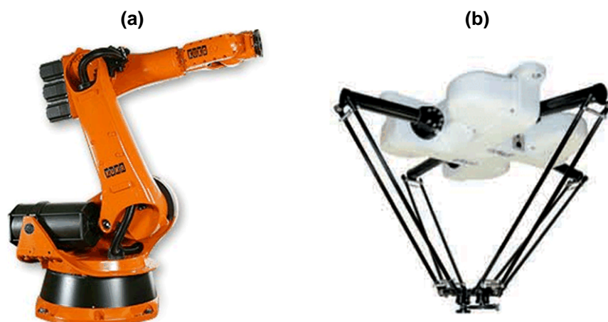
Figura 1 - Exemplos de robôs de cinemática serial (a) (KUKA, 2019) e paralela (b) (ADEPT, 2010).
