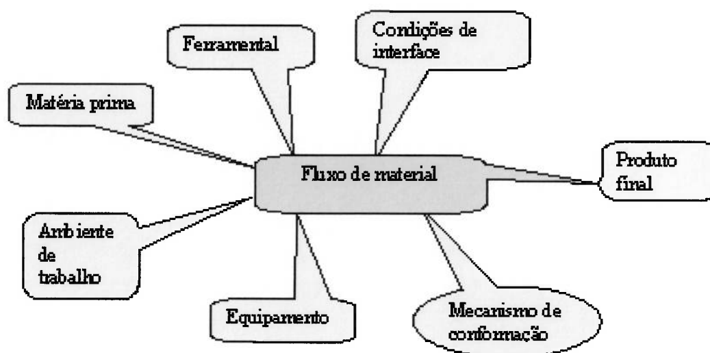
Figura 6 – Interligação entre as variáveis significativas no processo de conformação (9) .
