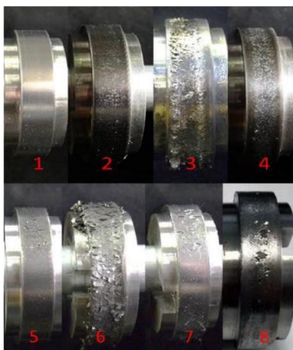
Figura 59 - Condição das superfícies dos discos em função da adição de lubrificantes: (1) condição inicial, (2) a seco, (3) água, (4) modificador de topo do boleto, (5) graxa de canto/lateral do boleto, (6) modificador de topo do boleto a base de óleo, (7) graxa de topo do boleto e (8) modificador de topo do boleto híbrido. Fonte: Hardwick, Lewis e Stock (2016).
