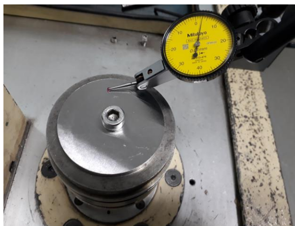
Figura 70 - Verificação do batimento (planaridade) dos discos antes dos ensaios de desgaste. Fonte: do autor (2018).
