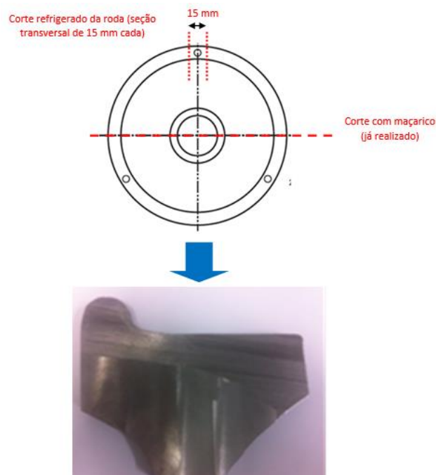
Figura 64 - Desenho esquemático para preparação dos perfis da roda. Fonte: do autor (2017).
