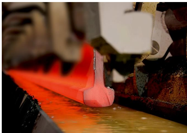
Figura 13 - Tratamento térmico para endurecimento do boleto do trilho, por meio de imersão em banho líquido. Fonte: site Voest Alpine (01/12/2021).
