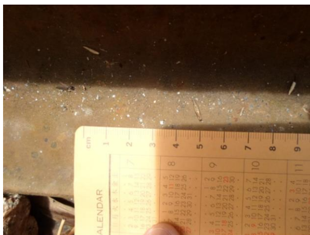
Figura 31 - Detritos metálicos sobre o patim do trilho alto de uma curva lubrificada. Tamanho máximo encontrado: 1 mm. Fonte: do autor (2021).
