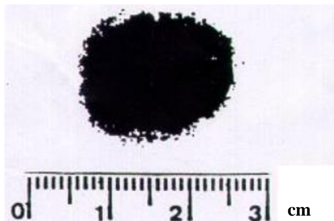
Figura 21 - Elipse de contato roda-trilho proveniente de vagão com 33 toneladas/eixo. Fonte: Alves (2000).
