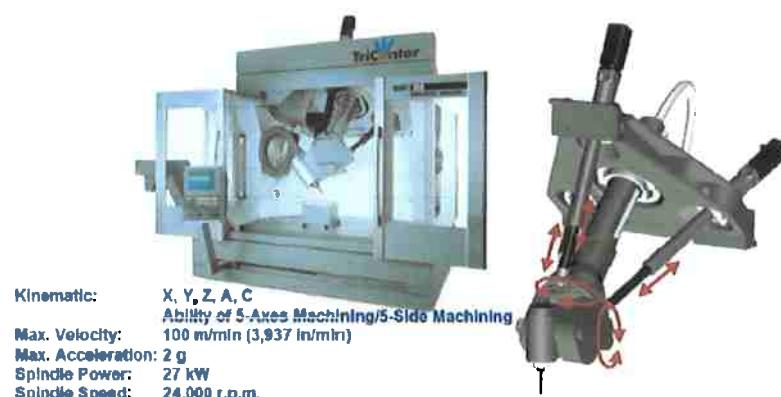
**Figura 1.9 Tricenter DMT 100 da Deckel Maho.**
