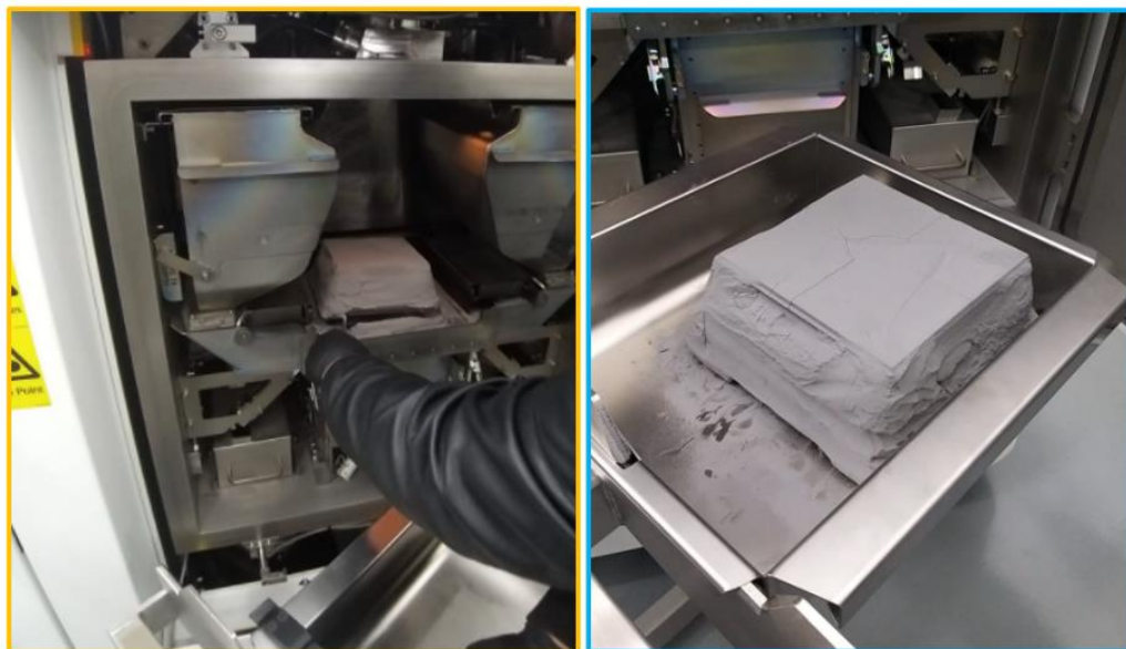
Fotografia 6 – Retirada amostras de tração e de ultrassom da ARCAM Leito de Pó de Ti-6Al-4V dez vezes reciclado
