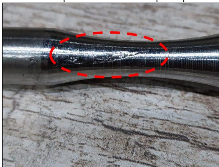
Fotografia 13 – Falha de preenchimento do corpo de provas na direção Y
