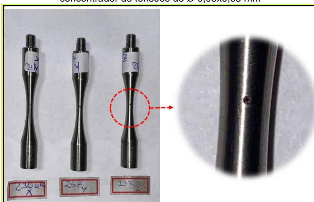
Figura 47 – Exemplo dos corpos de prova que foram realizados o furo entalhe concentrador de tensões de \varnothing 0,05 \times 0,05 mm
