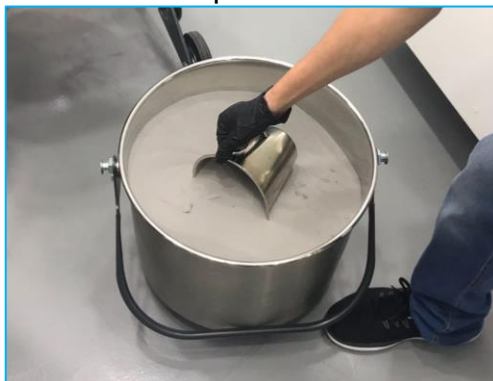
Fotografia 3 – Pó Ti-6Al-4V da AP&C reciclado dez vezes em preparo para impressão
