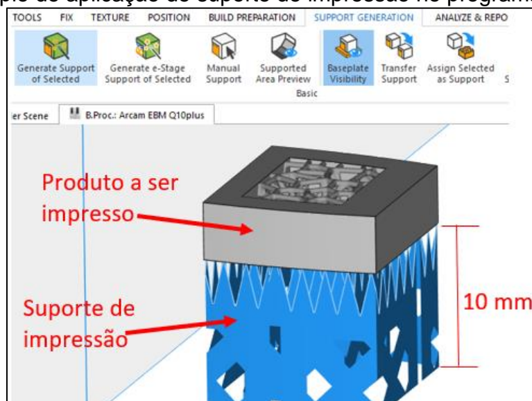
Figura 27 – Exemplo de aplicação de suporte de impressão no programa Materialise
