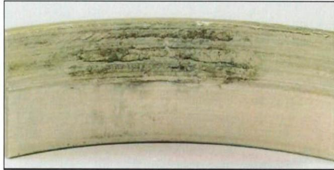
Figura 2.27: Engripamento na superfície de uma bronzina.
