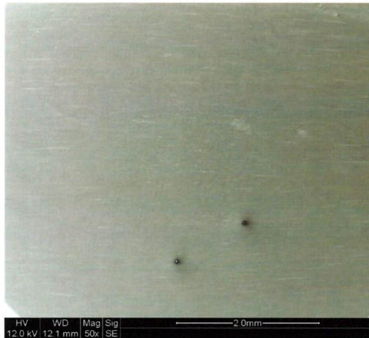
Figura 5.27: MEV/SEI – Superfície de Eixo sem Engripamento
