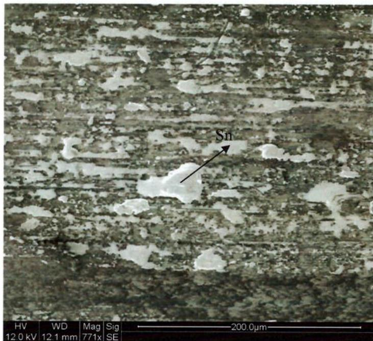
Figura 5.21: MEV/SEI – Superfície Eixo – Após Engripamento – Região A
