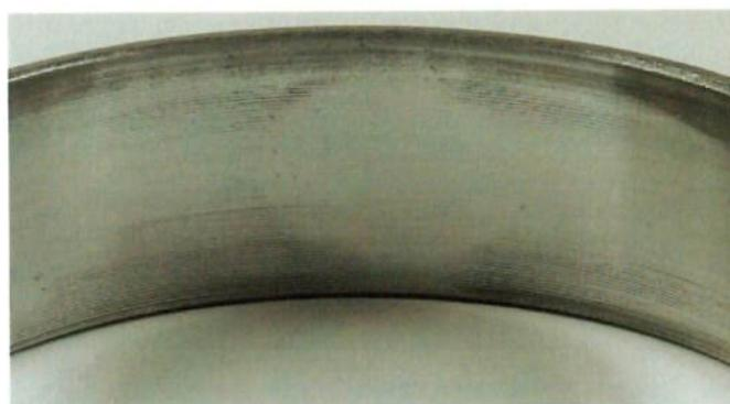
Figura 5.16: Visual Peça #4 – Acabamento Microperfilado
