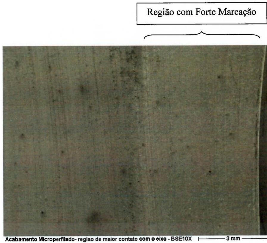
Figura 5.17: MEV/BSE - Peça Microperfilada – Região com Forte Marcação
