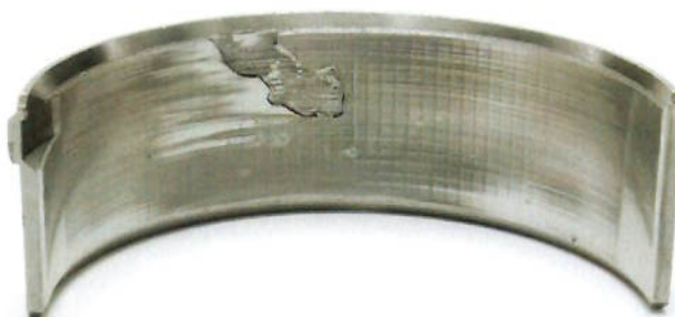
Figura 2.33: Fadiga de contato na superfície de uma bronzina – Destacamento de liga.
