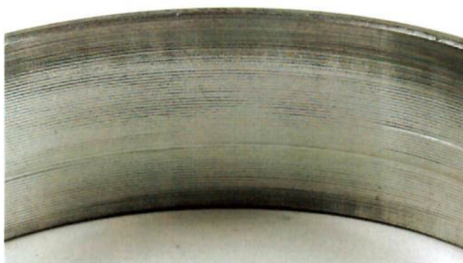
Figura 5.15: Visual Peça #3 – Acabamento Microperfilado Forte Marcação nas Bordas
