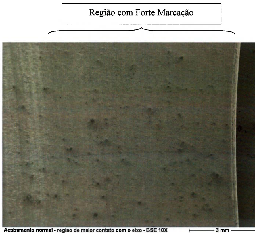
Figura 5.13: MEV/BSE - Peça Convencional – Região com Forte Marcação
