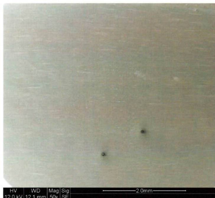
Figura 5.27: MEV/SEI – Superfície de Eixo sem Engripamento
