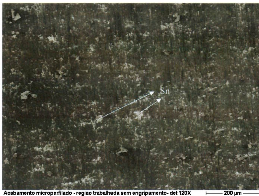
Figura 5.18: MEV/BSE - Peça Microperfilada – Região com Forte Marcação - Detalhe
