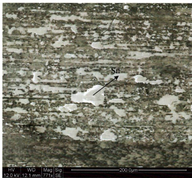
Figura 5.21: MEV/SEI – Superfície Eixo – Após Engripamento – Região A Presença de Estanho
