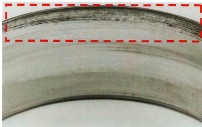
Figura 5.7: Visual Peça #5 – Acabamento Convencional Ocorrência de Engripamento na Borda
