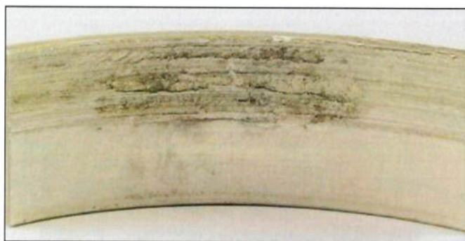
Figura 2.27: Engripamento na superfície de uma bronzina.
