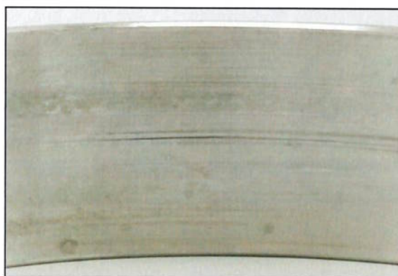
Figura 2.30: Riscamento na superfície de uma bronzina.
