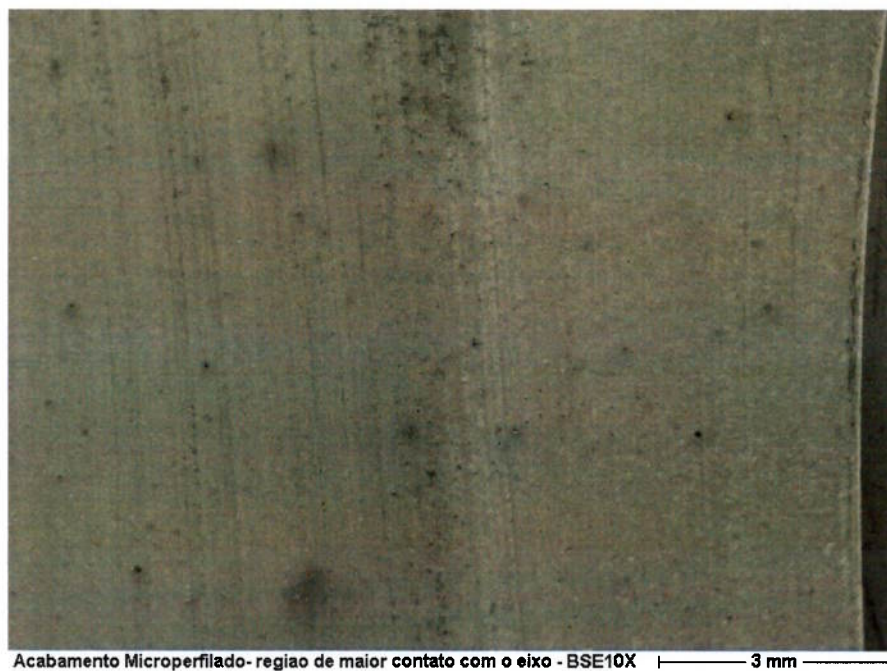
Figura 5.17: MEV/BSE - Peça Microperfilada – Região com Forte Marcação
