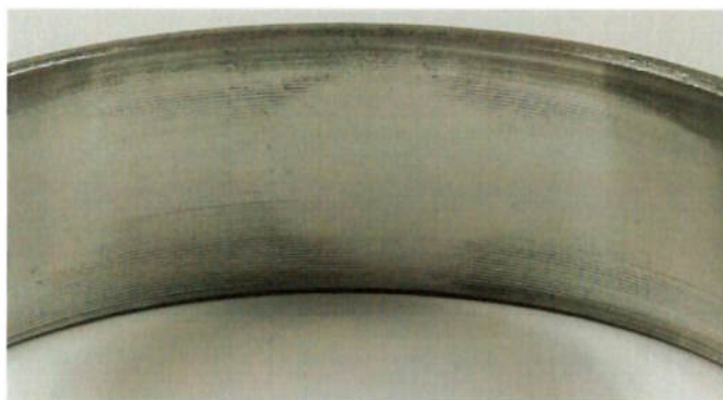
Figura 5.16: Visual Peça #4 – Acabamento Microperfilado Forte Marcação nas Bordas
