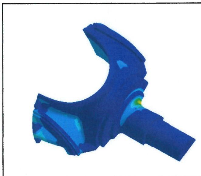
**Figura 1.18 – Resultado de Simulação Estrutural pelo Método dos Elementos Finitos para o Rotor da Válvula Esférica sob os Esforços Hidráulicos decorrentes de um Fechamento de Emergência (Voith Siemens)**
