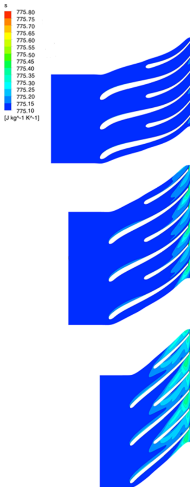
Figura 4.6 – Visualização em escala da entropia estática no impelidor para 20%, 50% e 80% de Span ao longo da envergadura
