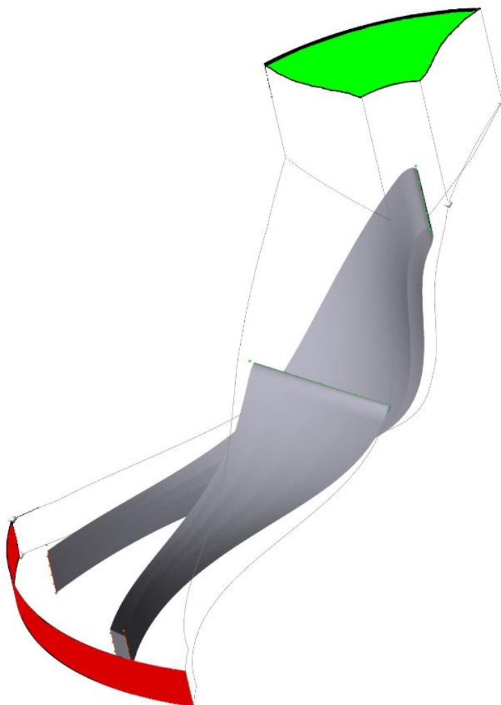
Figura 3.2 - Domínios de entrada em verde e saída em vermelho definidos para o problema do escoamento.
