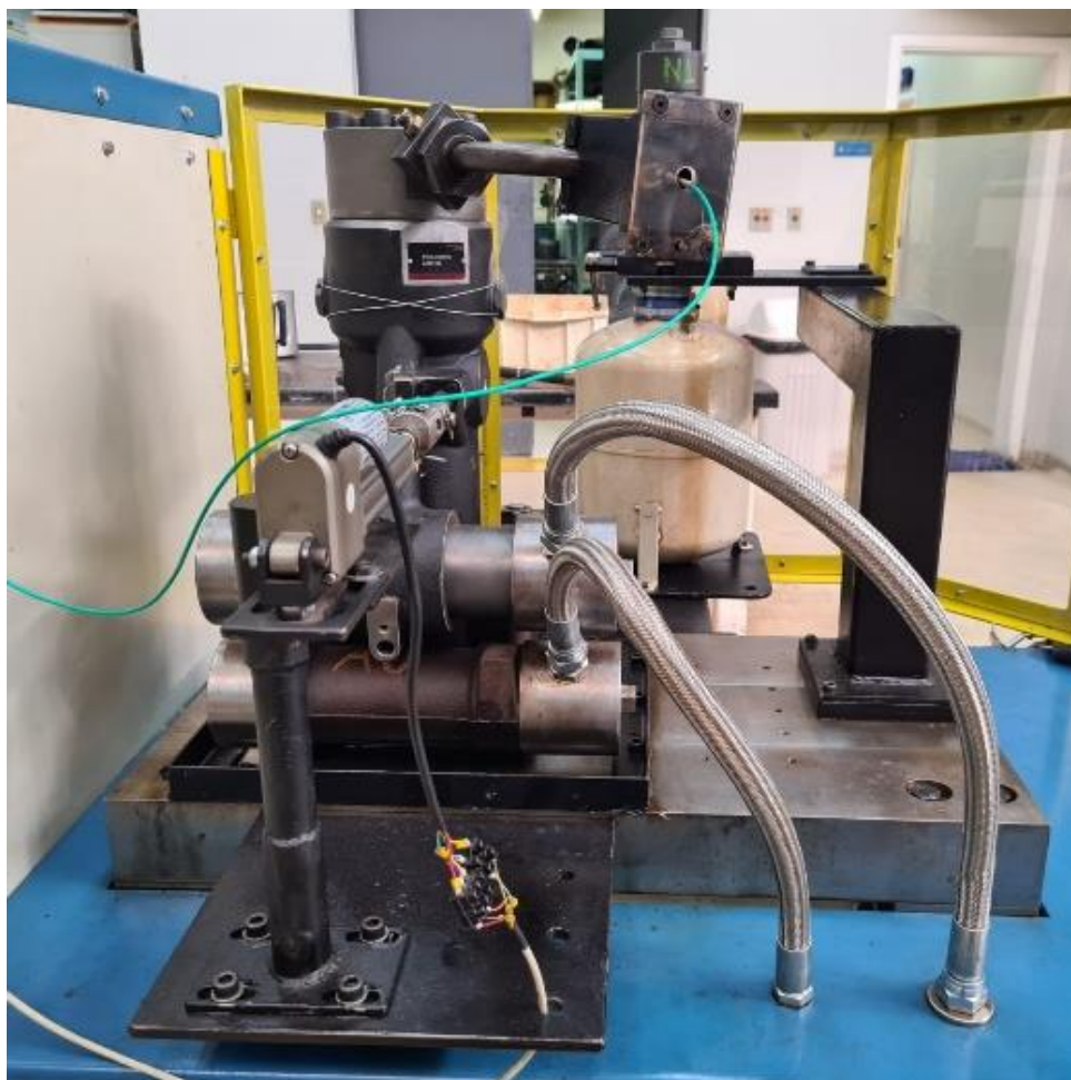
Figura 17 – Montagem do atuador linear
