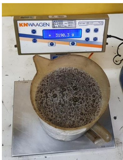
Figura 38 - Massa de fluido de teste pesada em balança externa
