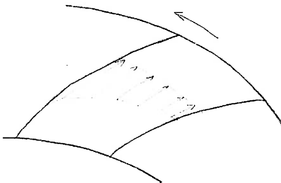
Figura 5 – Ilustração da distribuição de velocidades do fluido ao longo de uma seção do rotor centrífugo, mostrando o efeito da diferença de pressão entre os lados da pá na distribuição de velocidades.
