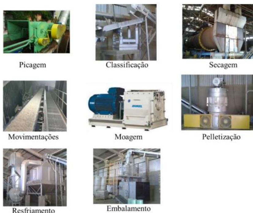
Figura 3-7 - Etapas de processamento do pellet de eucalipto.
