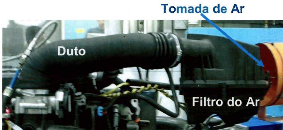
Figura 4 - Válvula borboleta, duto de ligação e filtro do ar
