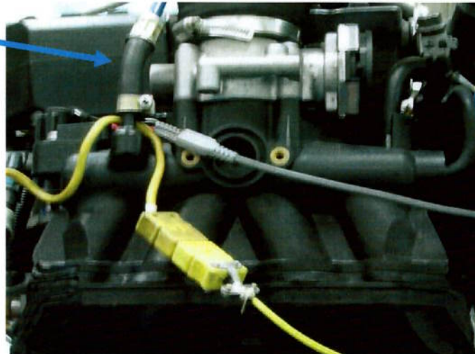
Figura 24 - Localização da tomada de pressão do coletor de admissão
