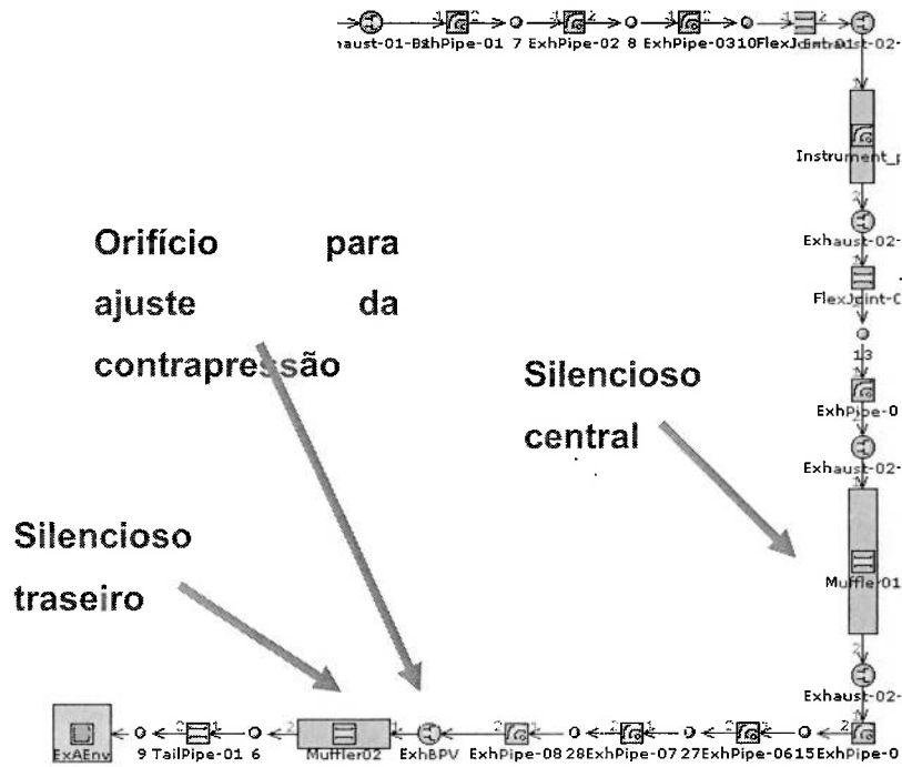
Figura 12 - Discretização do sistema de escape do veículo
