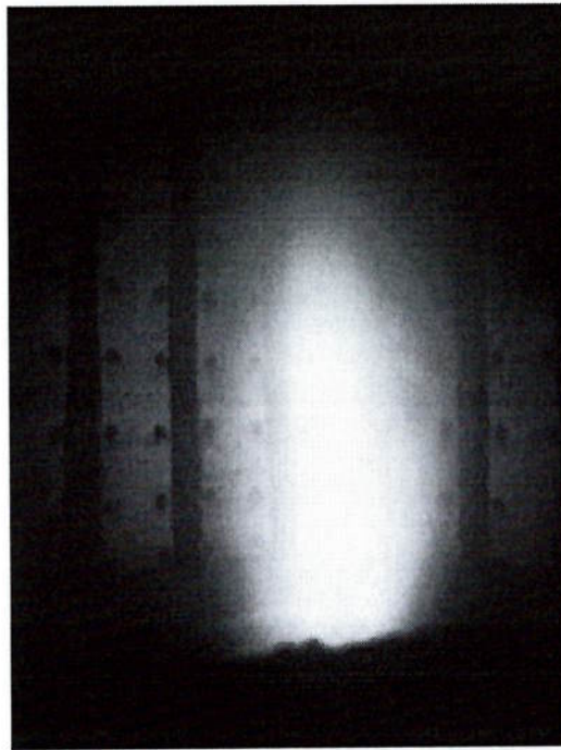
Figura 3.9: Chama com excesso de ar muito baixo (1%).
