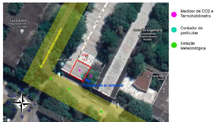
Figura 4.11: Trajeto do soprador e pontos de medição (VALENCIO E HERSCHANDER, 2021).
