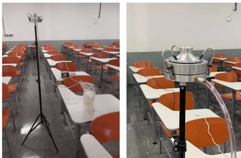
Figura 4.32: Conjunto de coleta de bioaerossóis montado na Sala A2 durante os ensaios.
