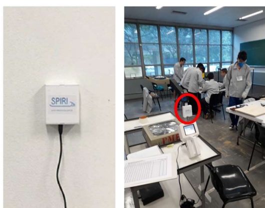
Figura 4.27: Exemplo de instalação dos multimetidores de QAI na Sala A2.
