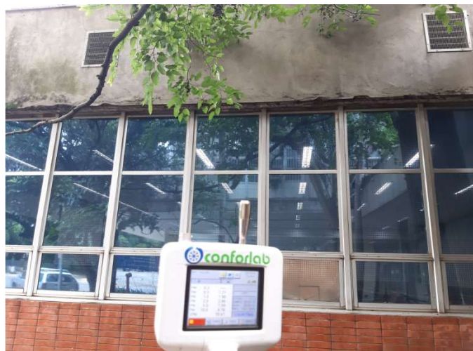
Figura 4.23: Medição de particulados na área externa com o contador de partículas.
