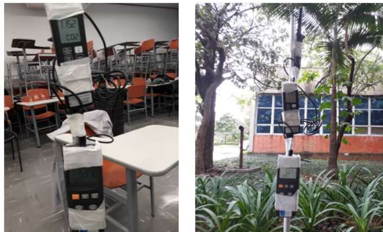
Figura 4.20: Exemplo de montagem da estação de medição utilizada nos experimentos.
