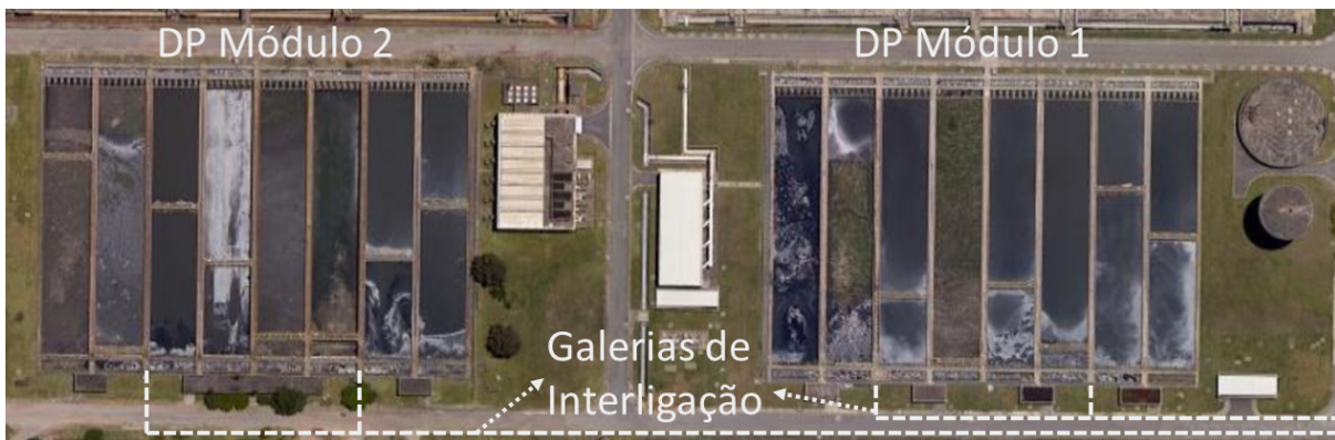
Figura 23 – Vista aérea dos Decantadores Primários dos módulos 1 e 2 e indicações das galerias em linhas tracejadas.
