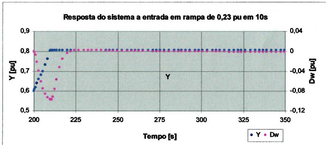
Figura 31. Saídas do modelo ( \Delta\omega e Y ) quando o sistema é submetido a entrada rampa \Delta P_G = + 0,23 pu
