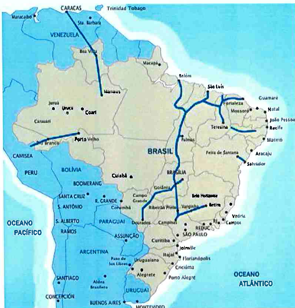
Figura 1.8 – Gasodutos em Estudo (PETROBRAS, 2006c)
