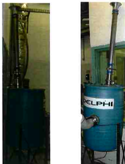
Figura 3.8 - Medidor de vazão de ar do tipo anemômetro e barril de 200 L
