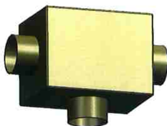
Figura 3.7 - Reservatório de dimensões significantes ou plenum
