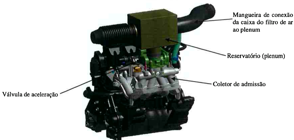
Figura 3.6 - Sistema de admissão de ar do motor testado com válvula de aceleração montada na posição original e reservatório (plenum) montado na posição horizontal com entrada da massa de ar filtrada pelo lado direito deste.
