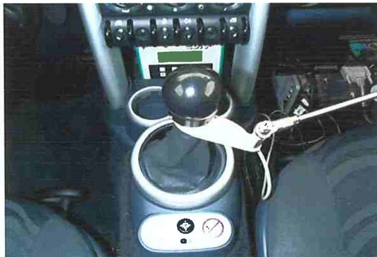
Figura 43 – Manopla instrumentada com células de carga
