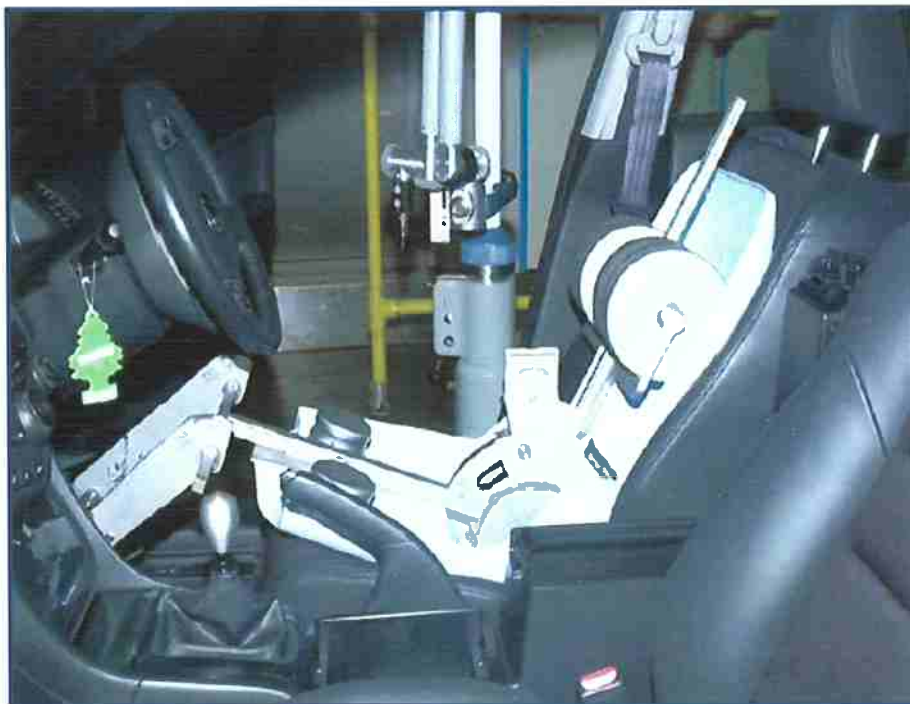
Figura 44 – Equipamento de medição de ponto H conforme SAE J826
