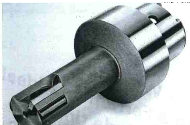
Figura 2.12- Ferramenta HSC com guias de diamante.
