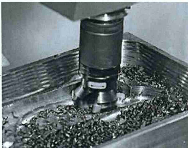
Figura 2.26 - Condições de alta rigidez para maiores concentrações de esforços.
