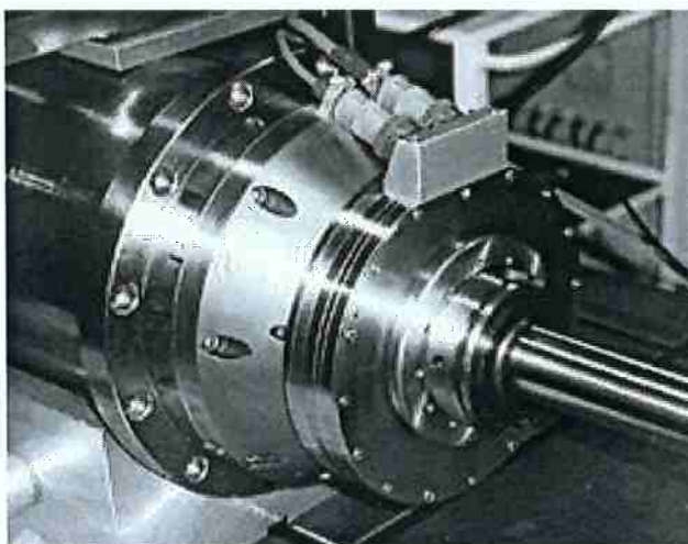
Figura 2.19 - Sistema de balanceamento automático, chamado de Bala Dyne.
