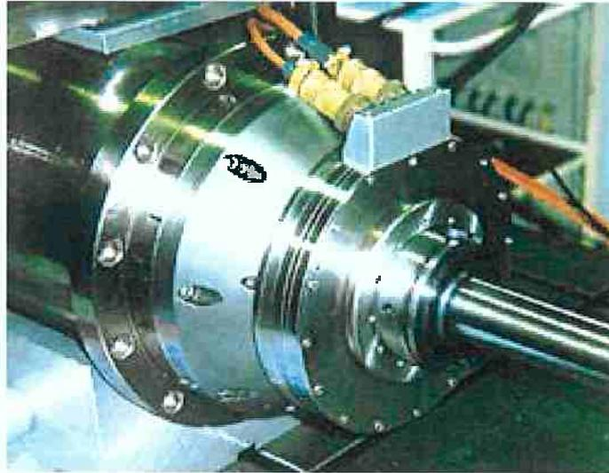
Figura 2.25 - Sistema de balanceamento automático, chamado de Bala Dyne.
