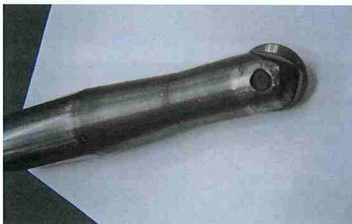
Figura 4.8 – Ferramenta Topo esférico para Inserto Diâmetro 25mm.
