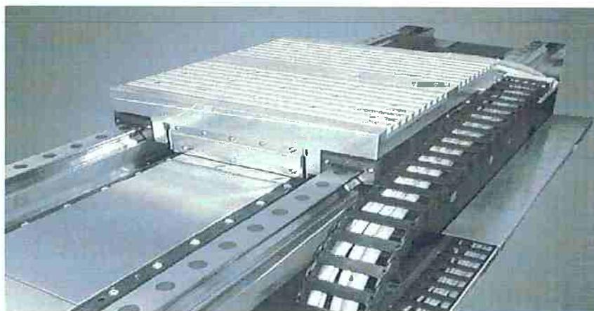
Figura 2.33 - Detalhe de guias lineares de uma máquina HSC.
