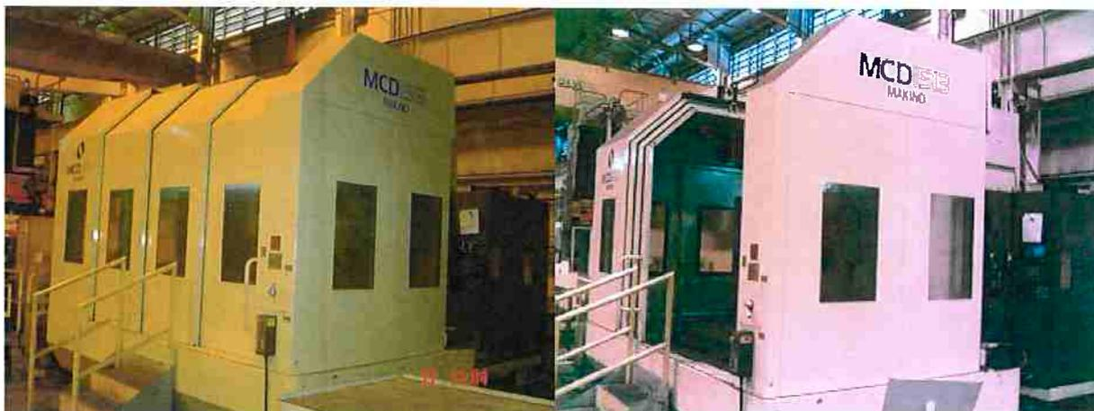
Figura 4.6 – Centro de usinagem MAKINO MCD1513.
