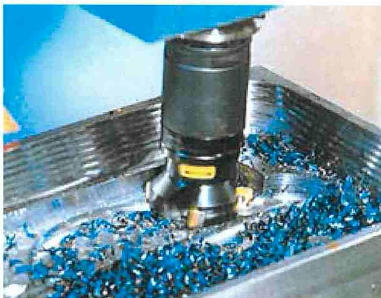
Figura 2.23 - Condições de alta rigidez para maiores concentrações de esforços.
