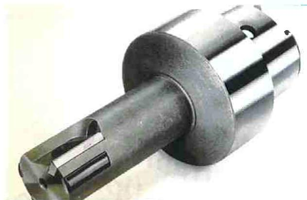
Figura 2.15 - Ferramenta HSC com guias de diamante.
