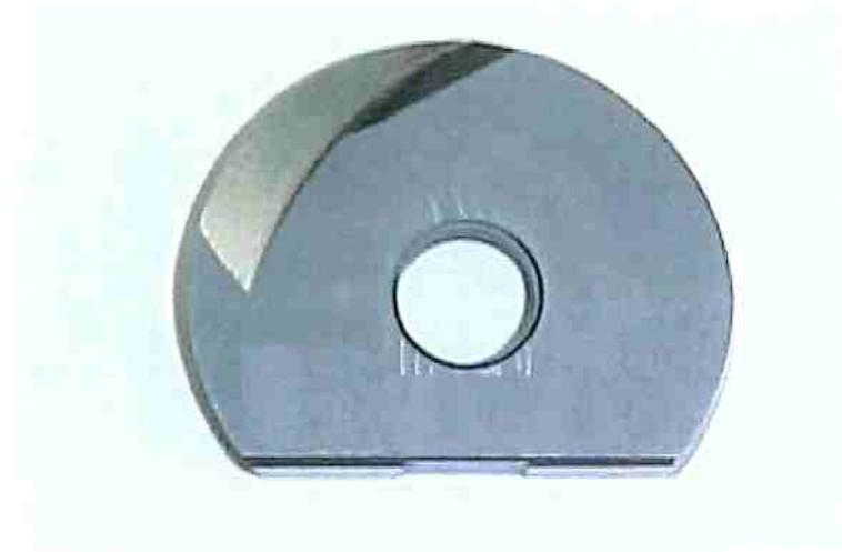
Figura 4.9 - Inserto Diâmetro 25mm.
