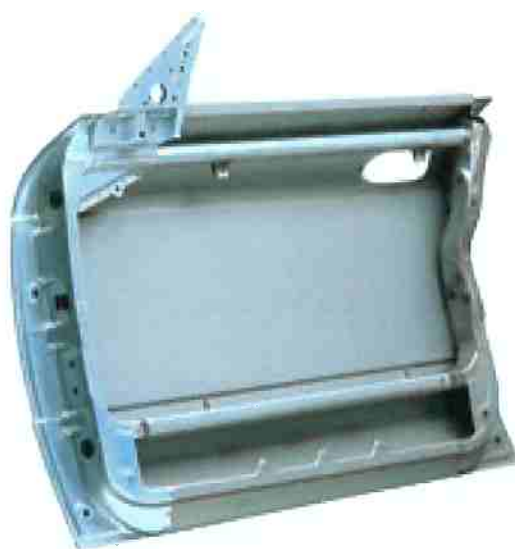
Figura 37. Montagem final da estrutura da porta dianteira do ULSAC DH.
