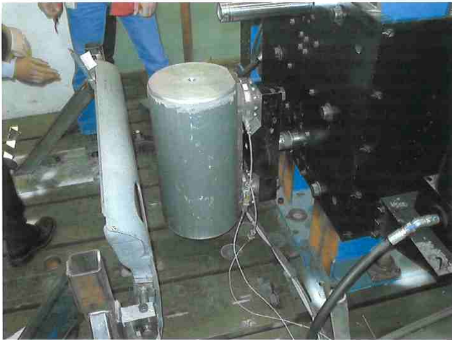
Figura 38. Teste de intrusão lateral
