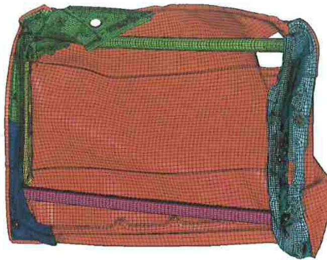
Figura 32. Amassamento longitudinal da estrutura de porta ULSAC.
