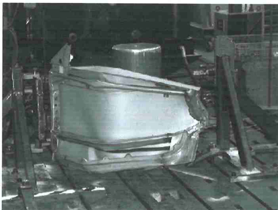
Figura 58. Porta do protótipo de demonstração após a intrusão lateral
