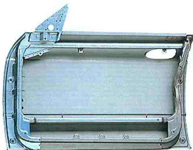
Figura 56. Montagem final da estrutura da porta dianteira do ULSAC DH.
