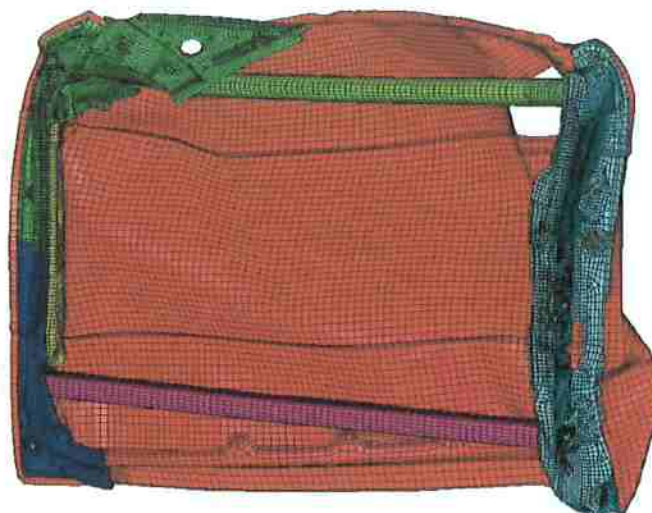
Figura 50. Amassamento longitudinal da estrutura de porta ULSAC.
