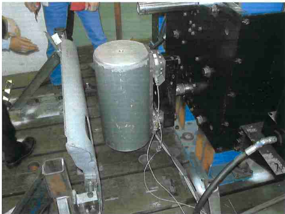
Figura 57. Teste de intrusão lateral
