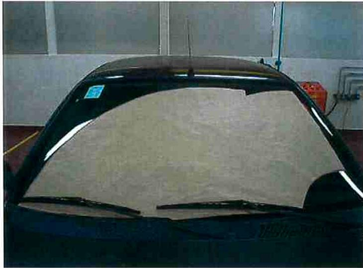
Figura 3.6: Eficácia de varredura do limpador de pára-brisa dianteiro.
