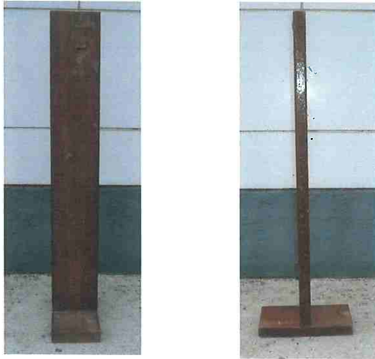
Figura 3.2: Obstáculo do experimento de visibilidade traseira.
