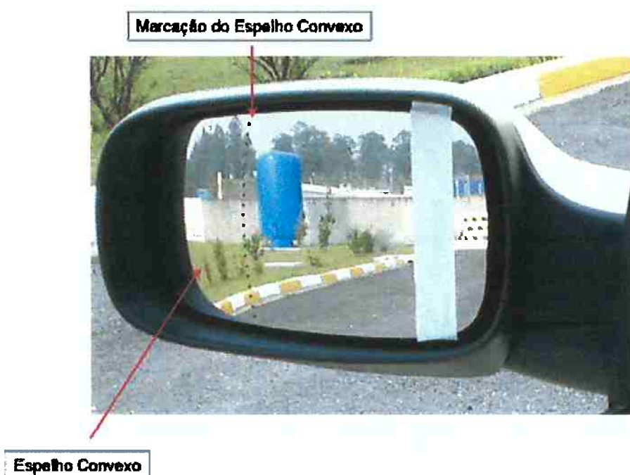
Figura 2.11: Exemplo de um espelho convexo combinado com um espelho plano.
