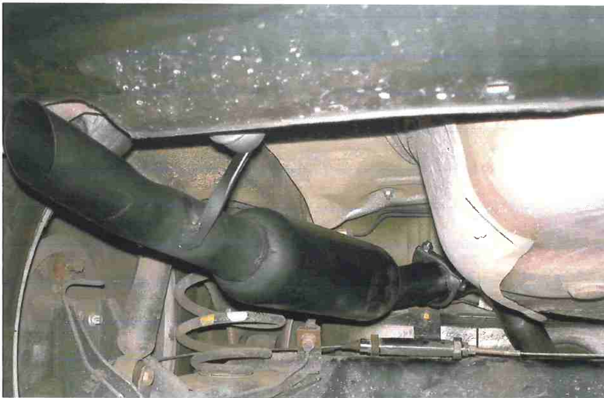
Fig. 07 – Escapamento 2,0pol para GM corsa com um abafador traseiro
