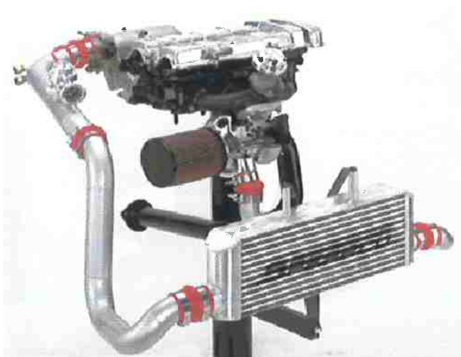
Fig. 08 – Tubulação de admissão
