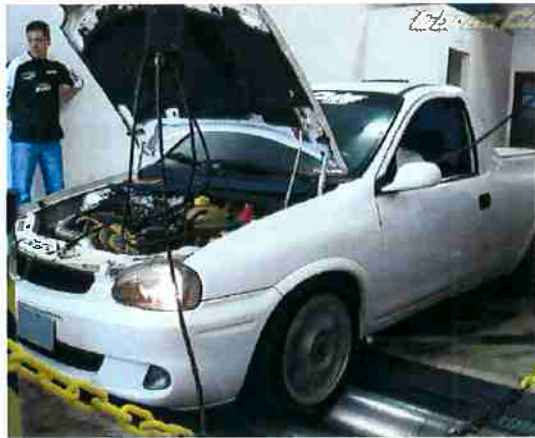
Fig. 29 – Veículo no dinamômetro
