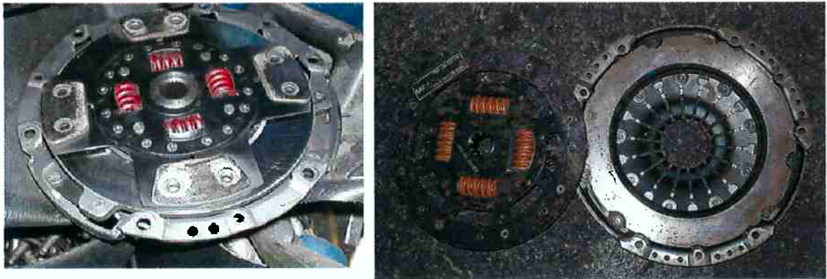
Fig. 11 e 12 – Embreagem de modelo com pastilhas de cerâmica e tradicional
