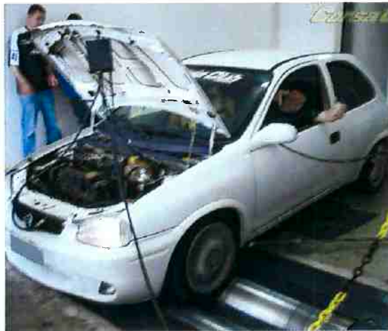
Fig. 32 – Veículo no dinamômetro
