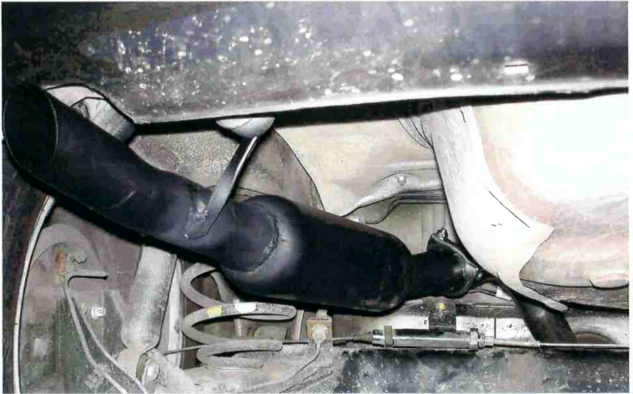
Fig. 07 – Escapamento 2,0pol para GM corsa com um abafador traseiro
