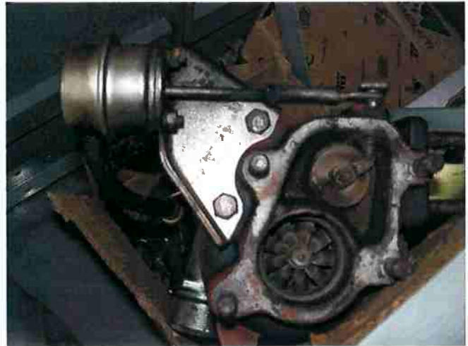
Fig. 19 e 20 – Válvula de alívio externa e integrada
