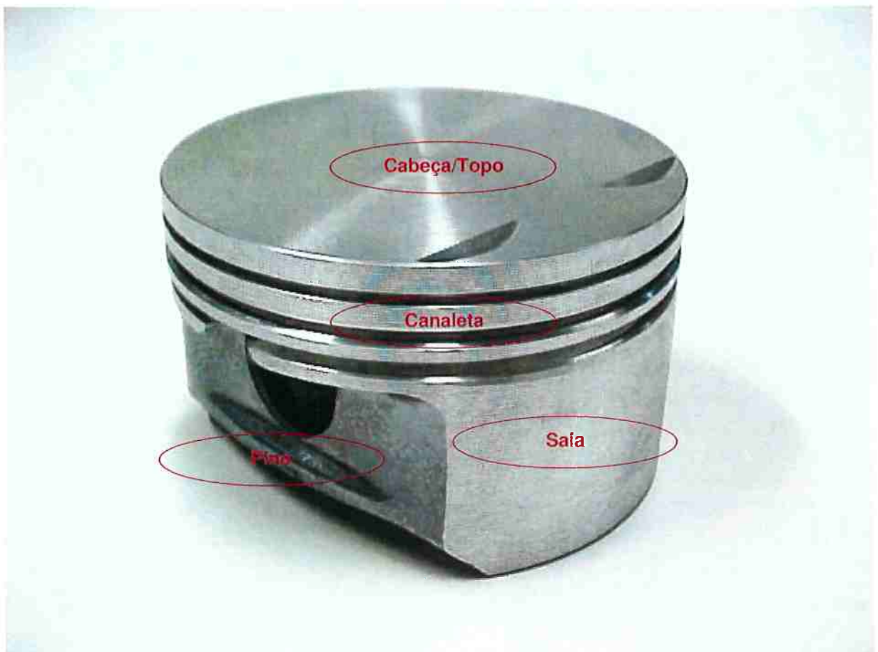
Fig. 03 - Pistão de motor à combustão interna ciclo Otto moderno
