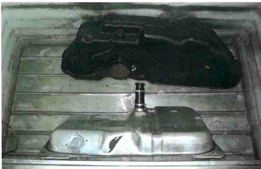
**Figura 64 – Amostras 02 e 03 condicionadas a temperatura de  $-40^{\circ}\text{C}$  por 24 horas.**
