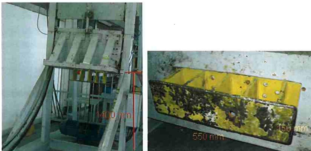
**Figura 63 – Características do dispositivo de teste de impacto**
