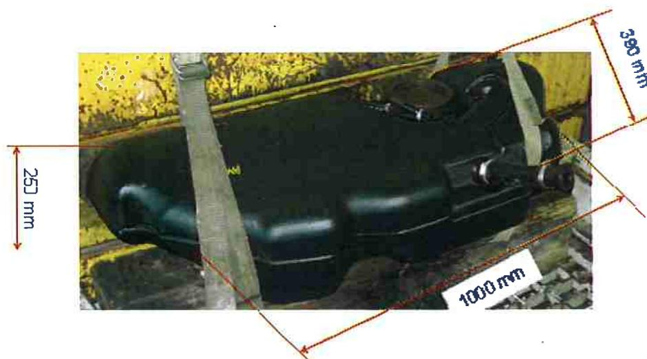
**Figura 60 – Dimensões básicas da amostra 01.**
