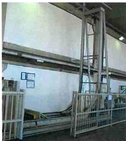
**Figura 62 – Dispositivo de teste para simulação de impacto (*Sled Test*).**
