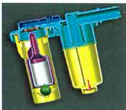
Figura 15 – Esquema de uma válvula Roll Over em corte.
