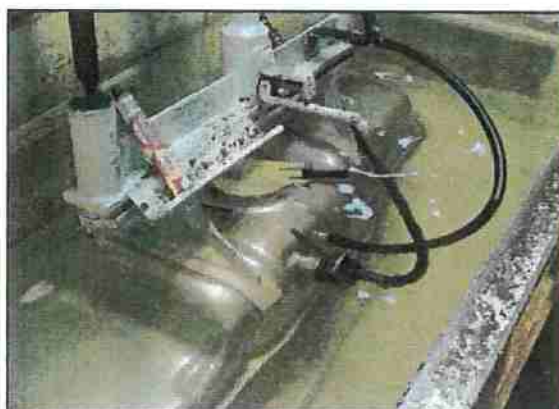
Figura 29 – Teste de verificação de vazamento em tanques metálicos de combustível.
