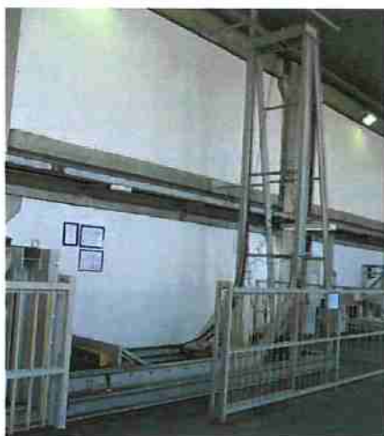
Figura 62 – Dispositivo de teste para simulação de impacto ( Sled Test ).
