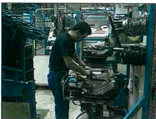
FIGURA 33 - Processo de montagem dos componentes do tanque plástico de combustível.
