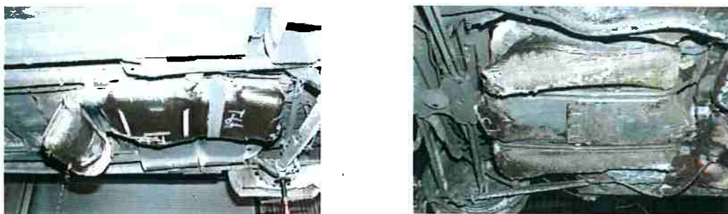
Figura 41 – Exemplos de tanques de combustível após teste de exposição ao fogo.
