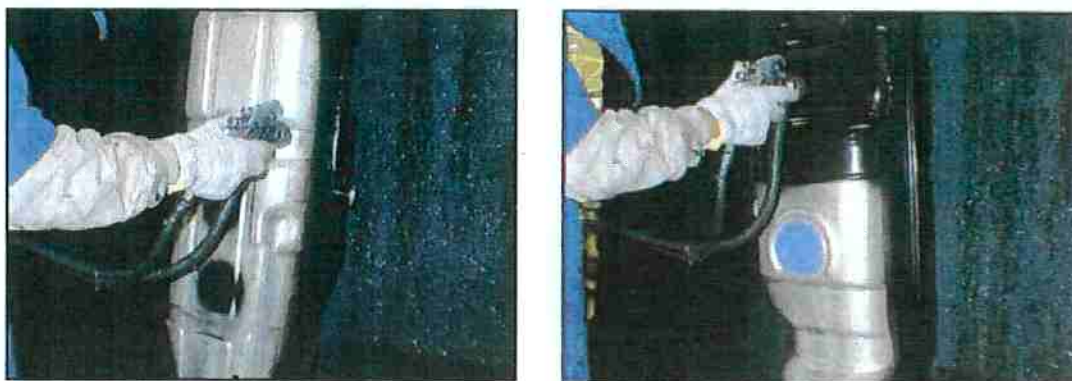
Figura 27 – Operação de pintura manual de tanques metálicos de combustível.
