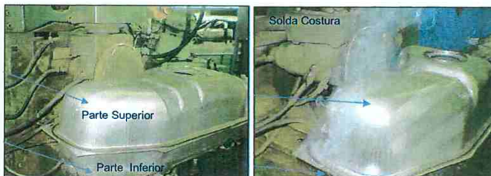
Figura 25 – Operação de solda por rolos (Costura) dos tanques metálicos de combustível.
