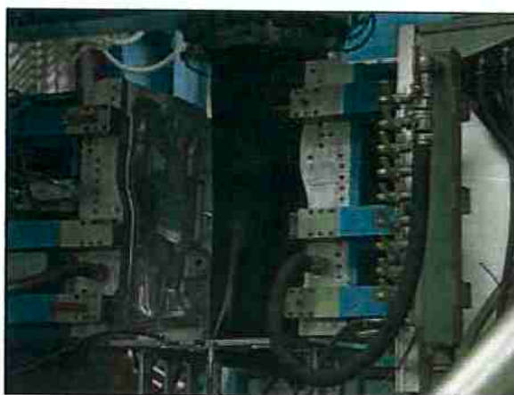
Figura 30 – Operação de Extrusão Sopro de tanques plásticos de combustível.
