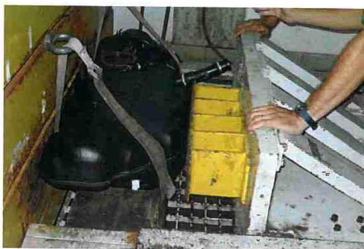
Figura 65 – Posicionamento do tanque de combustível para o ensaio.
