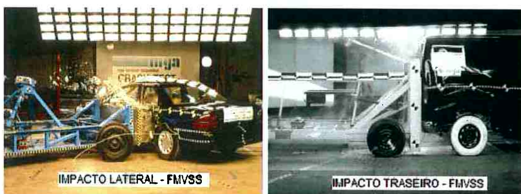
Figura 37 – Exemplos de veículos de passageiros submetidos aos testes de impactos laterais e traseiros conforme FMVSS 301.
