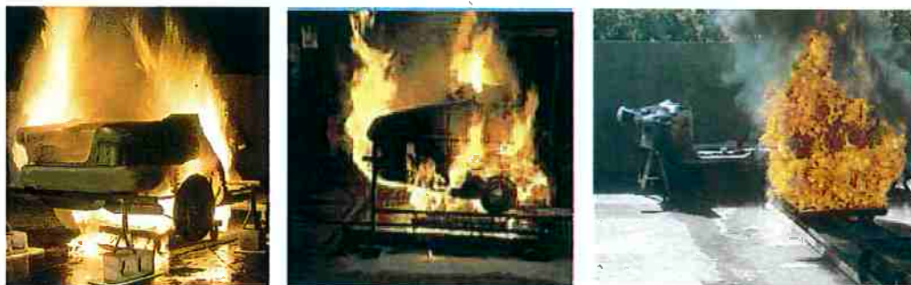
FIGURA 40 – Testes de exposição ao fogo para tanques plásticos conforme ECE R34 anexo 5.
