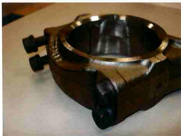
Figura 1.1 - Biela de motor Diesel montada com parafusos M12 - ISO898, classe 10.9.
