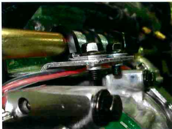
Figura 1.2 - Parafusos usados na fixação de tubos por abraçadeiras em um motor Diesel.
