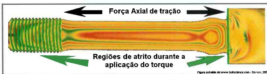
Figura 1.4 - Parafuso mostrando as superfícies que entram em contato com outras superfícies durante o rosqueamento e a direção da força de montagem. Mostrando também as linhas de concentração de tensões cuja descrição não foi divulgada pelos responsáveis pela página na Internet da qual a Figura foi obtida.
