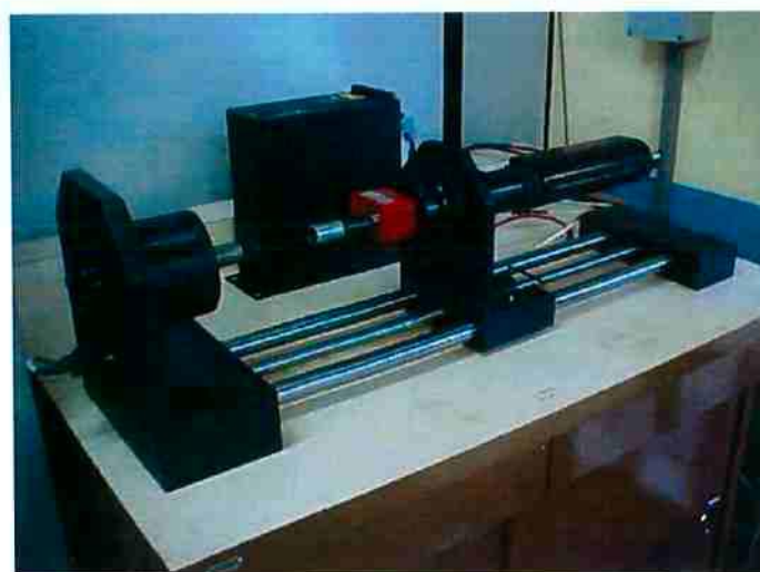
Figura 3.5 - Máquina de ensaio para a determinação da relação Torque / Tensão em parafusos
