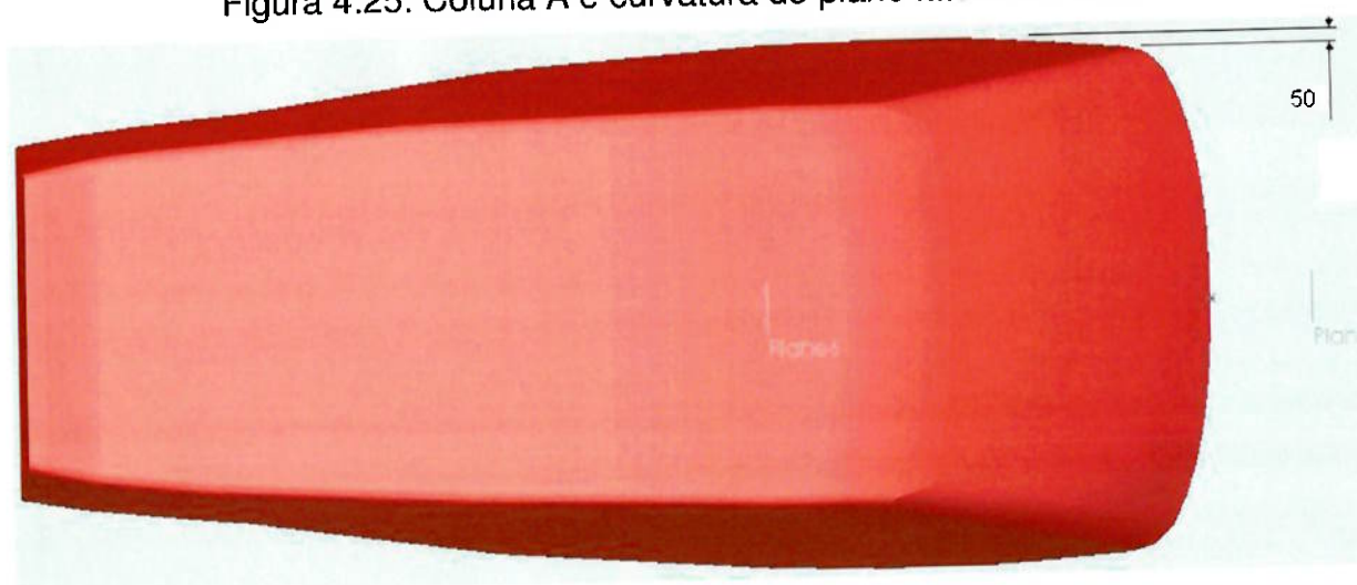
Figura 4.26: Coluna A e curvatura do plano lateral do teto na segunda versão.
