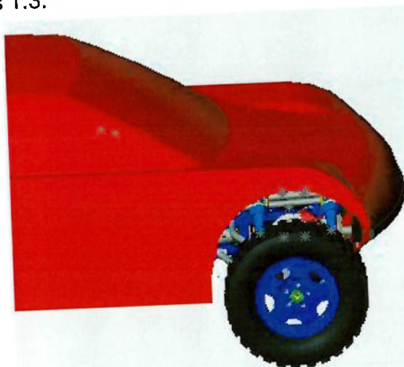
Figura 4.29: Aresta de interface do pára-brisas com o capô.
