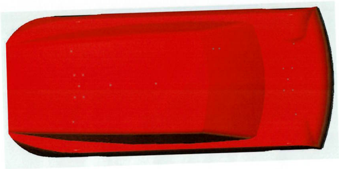
Figura 4.40: Boat-tailing do teto na primeira versão.
