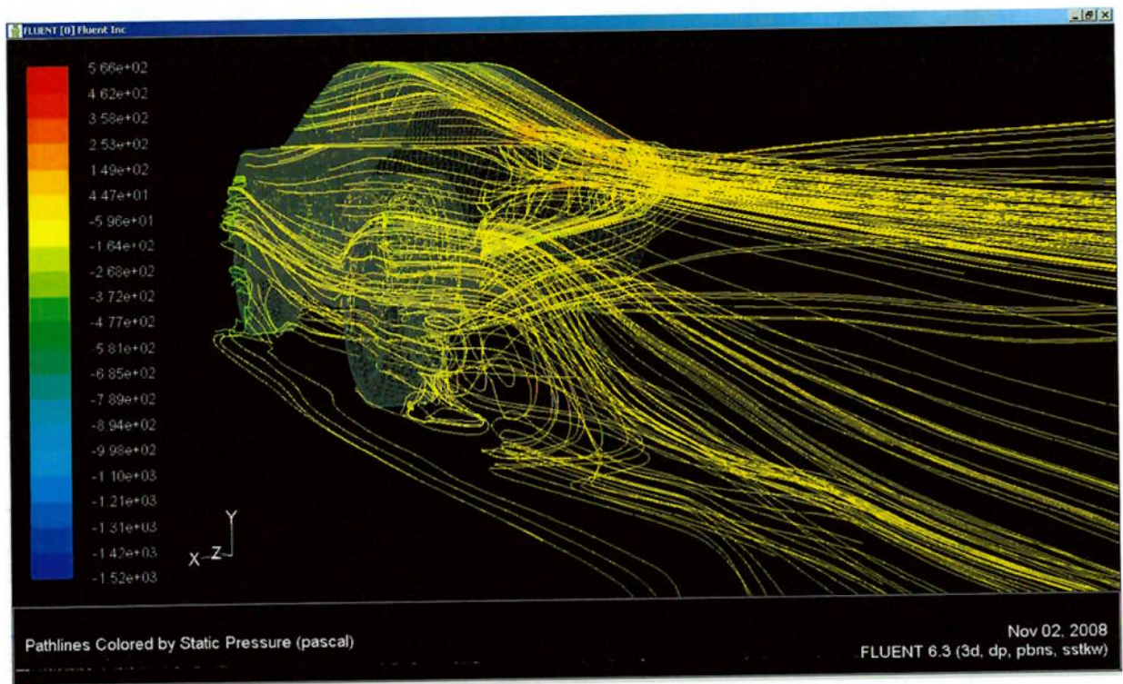
Figura 5.22: Linhas de fluxo na superfície do veículo, vista traseira.
