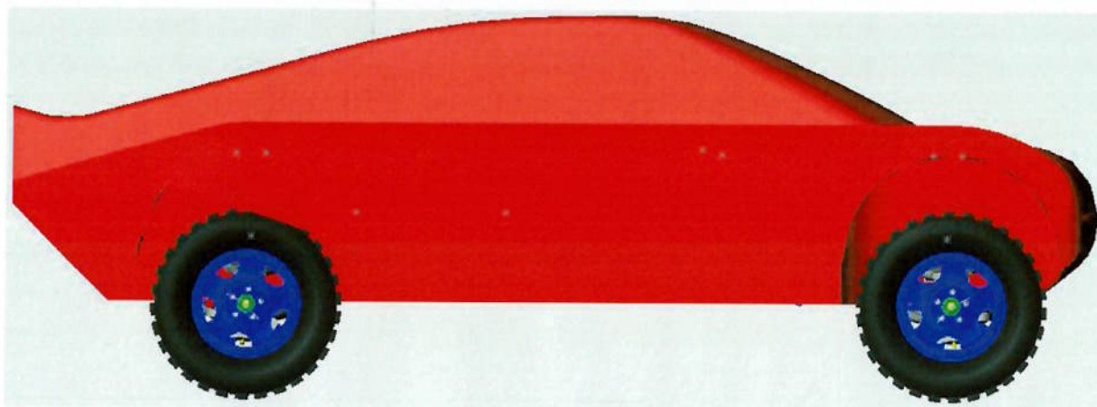
Figura 4.38: Inclinação da traseira e teto com spoiler de 15 graus.
