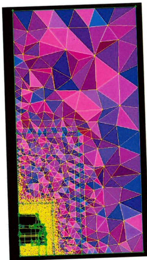
Figura 4.67: Malha final com corte e simetria para o veículo, corte transversal.
