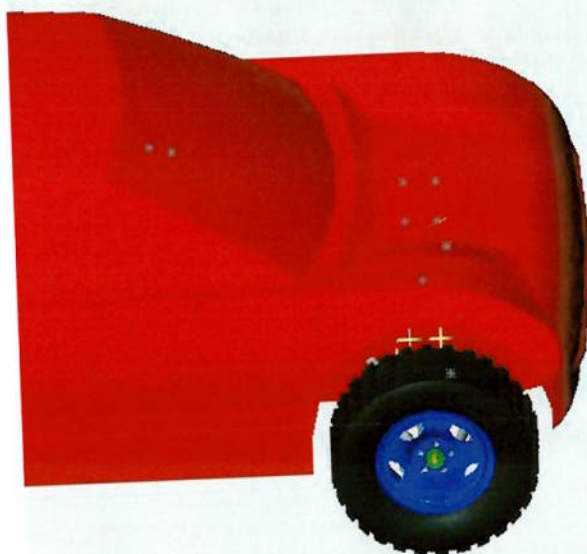
Figura 4.30: Modificação da aresta de interface do pára-brisas com o capô.
