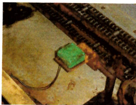
Figura 4.7 – Sensor de presença utilizado nas mesas de transferência e stops.
