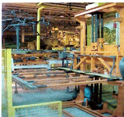
Figura 2.4 – Elevador da linha de lavagem.
