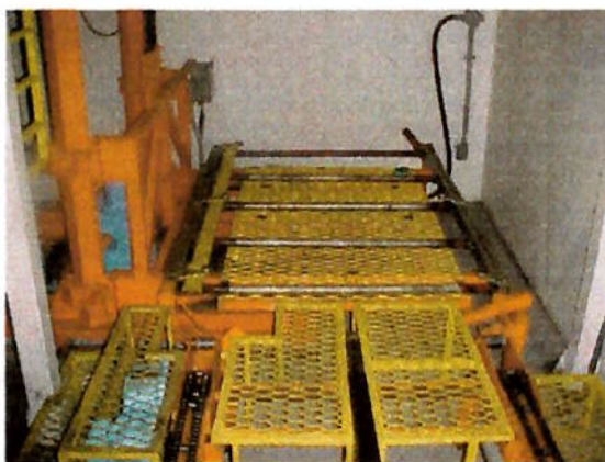
Figura 2.43 – Elevador de entrada da estufa.
