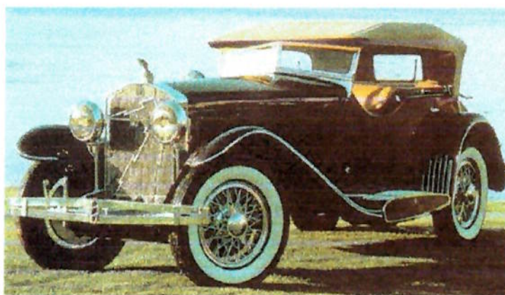
Figura 1.1 – Exemplo dos primeiros pára-choques empregados na indústria automobilística.
