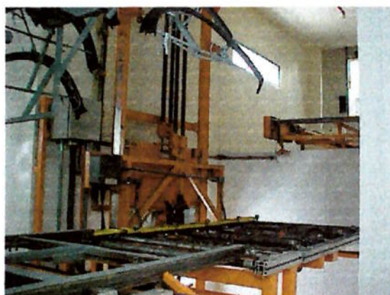
Figura 2.19 – Elevador de entrada das cabines.
